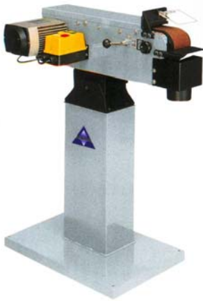
Universal-Stichschleifmaschine zum Schleifen von Profilformen
