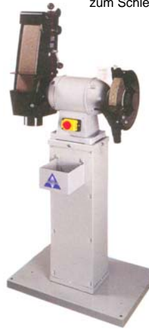
Universal-Kantenschleifmaschine zum Schleifen und Entgraten
